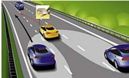
Der Spurwechsellassistent von Hella arbeitet mit Radarsensoren. Grafik: Auto-Reporter/Hella
